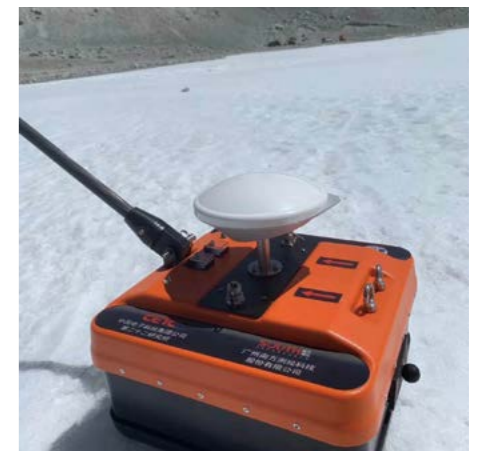
中国电科研制的雪深探测雷达
