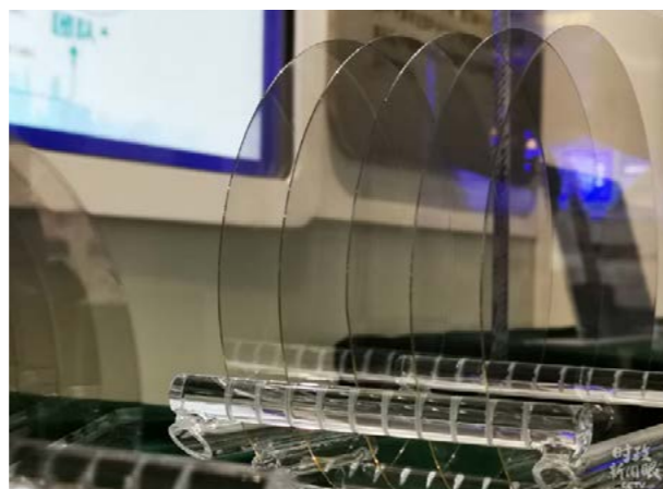
中国电科高纯度半绝缘 4H-SiC 单晶衬底
