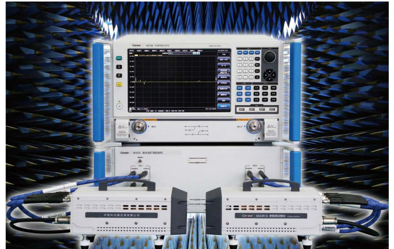
▲ 中国电科研制的国内首款 750GHz 太赫兹测试测量系列产品
